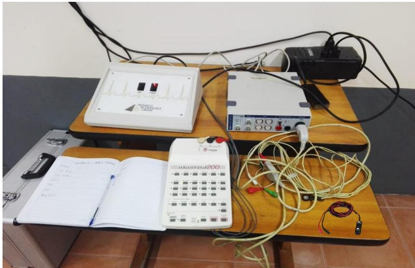
**Figura 4.2. Equipo de PowerLab para el registro de actividad.**
